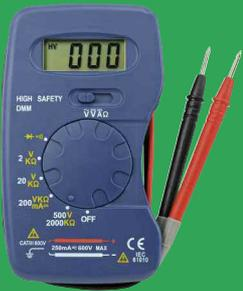
**CAT III 600 V.** Afficheur LCD 1999 points avec polarité. 5 positions. Test de diodes. Test de continuité. Livré avec cordons de mesure attachés.
