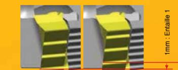
Les entailles sont efficaces à une profondeur de coupe supérieure à 3 mm
