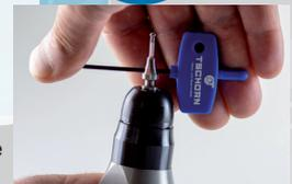
Vissage et dévissage faciles de la touche de palpé grâce au trou transversal.
