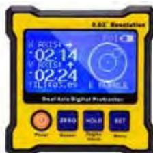
Mesure les angles en axe unique de 0 à 360°, à deux axes à +/- 40°. Résolution 0,02°, précision +/- 0,1°, gel de l'affichage, semelle en V, semelle et angles magnétiques. Affichage rotatif automatique. Batterie rechargeable 3,7 V Li-Ion. Dim. 70 x 70 x 28 mm. Poids 120g.
