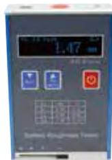
**Fonctions Ra et Rz.** Spécialement conçu pour le test de pièces usinées. Mesure en Ra de 0,05 à 10 µm, mesure en Rz de 0,1 à 50 µm.
