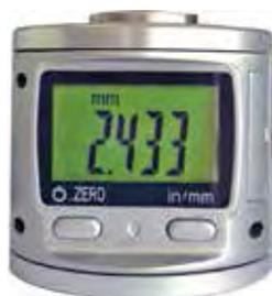
Pour rechercher le point zéro des outils sur machine et CNC. Protection IP65 contre projections de liquides et poussières. Hauteur 50 mm, course 2 mm. Lecture au 0,001 mm. Diamètre de la touche 25 mm. Base magnétique.
