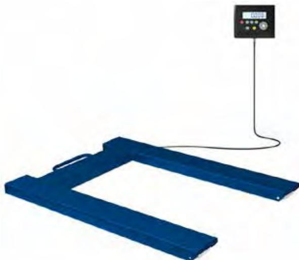
Plateforme à profil bas pour europalette, entièrement numérique. Roues frontales et poignée pour faciliter le déplacement. Faible hauteur pour accéder facilement avec le chargement. Pesée de palettes sans besoin de rampes. Acier recouvert de résine époxy durcie au four. IP65. Capacité 3000 Kg x 1 Kg. Dimensions 920 x 1260 x 84 mm. Alimentation 220 V. \*port en sus.
