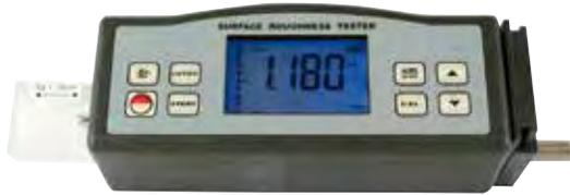
**Fonctions Ra et Rz.** Mesure en Ra de 0,05 à 10 µm, mesure en Rz de 0,02 à 100 µm. Sonde intégrée. Compatible avec les standards ISO, DIN, ANSI et JIS. Afficheur géant rétro-éclairé. Sonde en diamant, essai par inductance, rayon 10 µm, force de mesure 16 mN, angle 90°.
