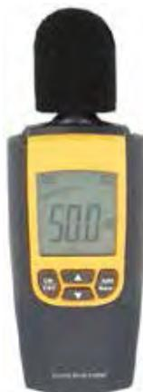
2 courbes de réponse : la courbe A qui correspond à l'oreille humaine pour mesurer les bruits d'environnement. La courbe C qui correspond à la courbe de réponse "plate" pour mesurer le bruit des machines. Mesure de 30 à 120 dB, fréquence de 31 Hz à 8 KHz. Résolution 0,1 dB. Précision 2 dB. Fonctions maxi et hold. Dim. 124x60x30 mm. Poids 180 g.
