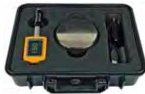
Compact, pour tester un large éventail de pièces avec 6 type d'angles d'impact sur 360°. 10 types de métaux : acier, aluminium, bronze, fer, laiton, cuivre... 6 échelles : HLD 200 - 960, HB 30 - 650, HRC 20 - 68, HRB 14 - 100, HV 80 - 976, HS 27 - 99. Sonde type "D". Mémoire de 1000 groupes de mesures de 2 à 6 tests avec moyenne. Grand afficheur OLED très lisible. **Livré complet avec bloc étalon de dureté et logiciel.** Avec sortie USB 2.0.
