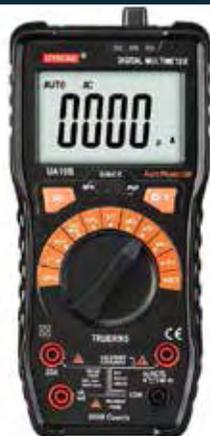
**CAT III 1000 V et CAT IV 600 V.** Ecran LCD 4 digits rétro-éclairé, 6000 points avec bargraphe. **TRUE RMS** : pour une lecture exacte de toute forme d'onde AC, calcul de la valeur calorifique d'après la formule de la valeur efficace (moyenne quadratique). Sélection automatique des gammes de mesure. Mémoire. Tests de diode, de transistor, de continuité avec buzzer, fonction **VAT** et lampe. Livré avec cordons de mesure et sonde type K.
