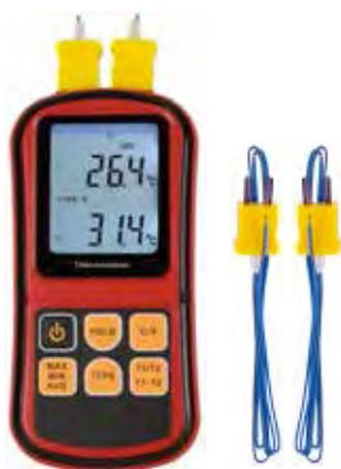
Thermocouple type K avec 2 entrées. 7 types de thermocouple : K, J, T, E, R, N, S. Résolution 0,1 °C. Ecran LCD rétro-éclairé 2 lignes.
