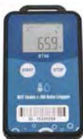
Mesure enregistre et transmet les données de température et humidité instantanément. Bluetooth 5.0. Stockage de 32 000 points de mesure paramétrable. Transmission jusqu'à 120 mètres des données. Possibilité de suivre de multiples Dataloggers à la fois sur l'appli. Alarme paramétrable. Température de -20° à 60°C, précision 0,3°C. Humidité de 0 à 90% RH, précision 3% RH. Dim. 86x48x12mm.
