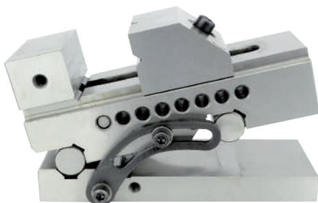
Etau de haute précision sans vis. Entièrement rectifié. Capacité 0-60°. Parallélisme et perpendicularité de 0,015 mm. Acier trempé 55-60 HRC.
