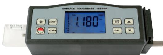
**Fonctions Ra et Rz.** Mesure en Ra de 0,05 à 10 µm, mesure en Rz de 0,02 à 100 µm. Sonde intégrée. Compatible avec les standards ISO, DIN, ANSI et JIS. Afficheur géant rétro-éclairé. Sonde en diamant, essai par inductance, rayon 10 µm, force de mesure 16 mN, angle 90°.
