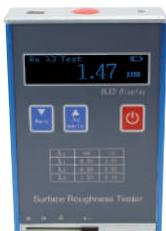
**Fonctions Ra et Rz.** Spécialement conçu pour le test de pièces usinées. Mesure en Ra de 0,05 à 10 µm, mesure en Rz de 0,1 à 50 µm. Afficheur géant rétro-éclairé. Sonde piézo-électrique avec protection. Course du palpeur 6 mm. Cut off : 0,25/0,8/2,5 mm. Arrêt automatique. Batterie rechargeable Li-ion, utilisation possible pendant la charge.
