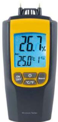
Grand afficheur LCD rétro-éclairé. Lecture du % d'humidité du bois, plâtre, mortier, béton de 0 à 95,7%. 7 matériaux sélectionnables en mémoire. Thermomètre de -10 à +50°C. Commutation °C/°F. Dim. 120x60x30x mm. Poids 180 g.
