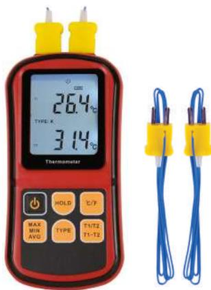
Thermocouple type K avec 2 entrées. 7 types de thermocouple : K, J, T, E, R, N, S. Résolution 0,1°C. Ecran LCD rétro-éclairé 2 lignes. Fonctions : °C/°F, mémoire, mini, maxi, moyenne, différence. Dim. 70x30x145 mm. Poids 126 g. Mesure de la température selon sonde employée : -50 à +1300°C, voir tableau repère 4.
