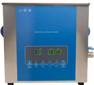
Applications : pièces mécaniques, industrie, optique, laboratoire, horlogerie, électronique... Fréquence 40 Khz. Minuterie. Cuve inox. Alimentation 220 V. Chauffage 0-80°C. Panier inclus. Robinet de vidange à partir de 9L.
