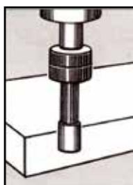
2 – La pinule entre en contact avec la pièce et tourne rond.
